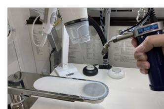
▲修理依頼の半分以上を占めるというシミ抜き。工房内には高性能のシミ抜き機を設置。環境に配慮した、服にも人にもやさしい溶剤を使用している。
